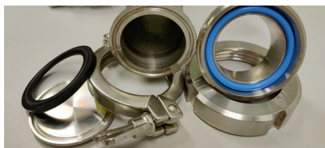
Figura 1. (a) Detalle de la conexión CLAMP (Tri-clover-Tri-CLAMP) a la izquierda frente a la DIN 11851 a la derecha; (b) Juntas para conexión DIN 11851 DN50 de diferentes materiales: Q/VMQ, NBR, PTFE, FKM/FPM y EPDM (de izquierda a derecha).
