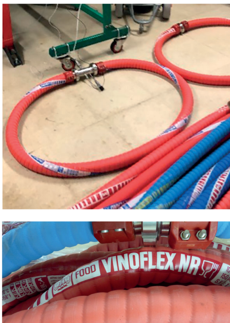
Figura 2. (a) Detalle de las mangueras con conector DIN 11851; (b) Vista del anillo de caracterización de las mangueras de diferentes materiales (IVG Colbachini, Padua, Italia): manguera de pared dura para aspiración y suministro de alcoholes hasta 96° sin alterar su olor ni sabor.
