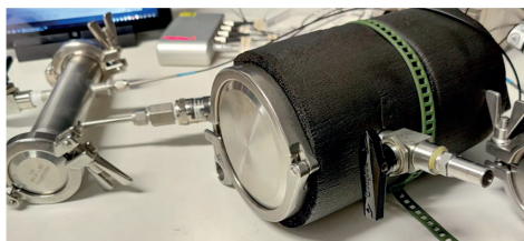
Figura 3. Detalle de los tres tamaños de conectores CLAMP ensayados (DN32, DN50 y DN80) con ambos tapones ciegos y en los que se ensayó OTR para dos juntas.
